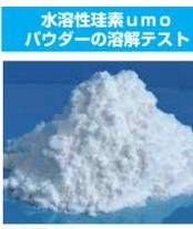
水溶性珪素umoパウダーの溶解テスト... 試験結果 沈殿することなく、ほぼ溶解状態となり60分後の珪素含有量は287ppmを計測。
